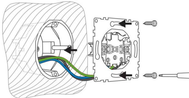
10. При установке механизма в специальное заводское отверстие железобетонной панели (без монтажной коробки), или в монтажную коробку без винтовых креплений, зафиксировать механизм распорными лапками, затянув винты по бокам фронтальной части механизма. Распорные лапки механизма не должны касаться или зажимать проводов во избежание повреждения их изоляции.
