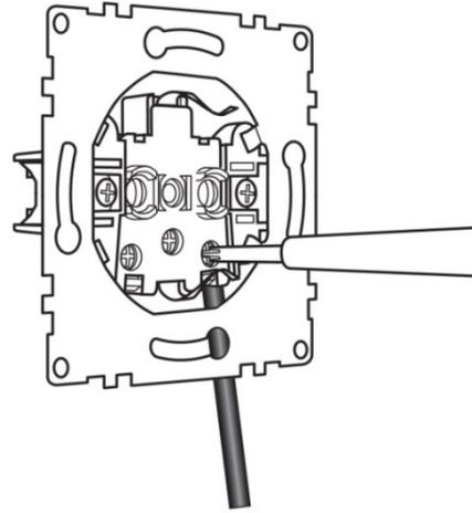
9. Вставить механизм розетки с присоединёнными проводами в монтажную коробку аккуратно, чтобы не повредить провода и не нарушить надёжность их присоединения. Избегать перегибов и замятия проводов. Провода должны лежать в коробке свободно. При необходимости, удалить крепёжные лапки. Прижать металлическое кольцо механизма к коробке. Надёжно зафиксировать кольцо винтами, входящими в комплект монтажной коробки.
