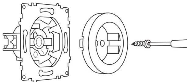
5. Для розеток с заземляющим контактом (1E1010130x, 1E1020130x, 1E1050130x):
