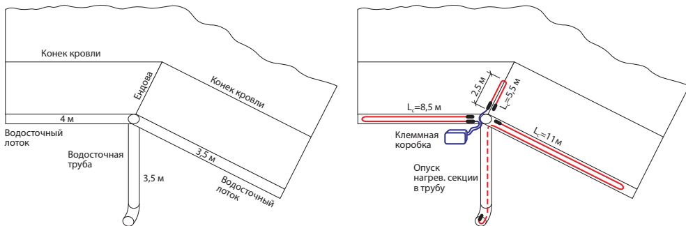
Рис. 8. Пример: Зоны обогрева (слева) и разложенные секции в зоне обогрева (справа).
